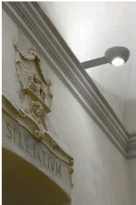
FIGURA 53 • Brescia, Complesso dei Chiostri del Carmine. Ex-refettorio del '500: nuova sala di lettura e per conferenze. Dettaglio delle decorazioni e dei nuovi elementi illuminanti bidirezionali.
